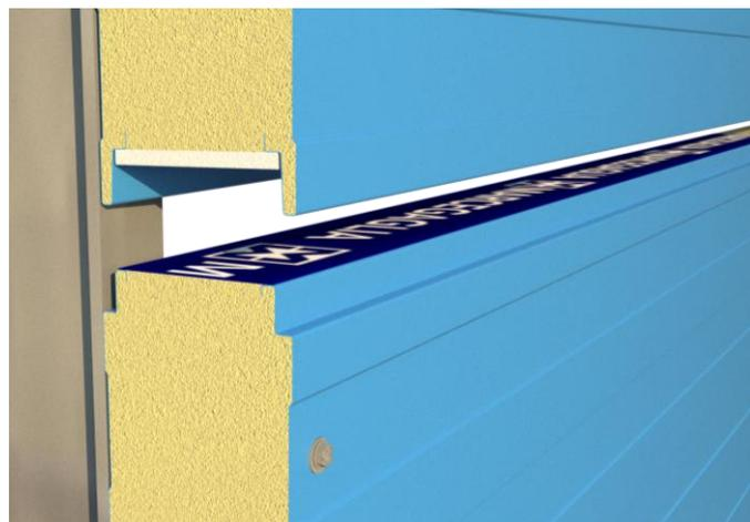
Fissare con le viti adeguate anche il secondo pannello ai montanti strutturali in uno dei due modi mostrati nelle immagini che seguono.
