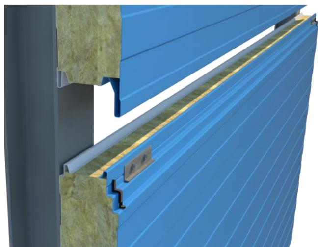
Verificare la perfetta orizzontalità del pannello e fissarlo con le viti passanti ai montanti strutturali lungo entrambe le testate del pannello e quindi in prossimità del giunto maschio interponendo tra le viti e il pannello una piastra di distribuzione in acciaio. Le viti dovranno essere di lunghezza appropriata (cfr. la sezione relativa alla posa verticale).
