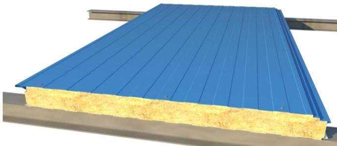
Fissare alla carpenteria retrostante il pannello lungo entrambe le testate con viti passanti e successivamente il giunto maschio interponendo tra le viti e il pannello una piastrina di rinforzo in acciaio.
