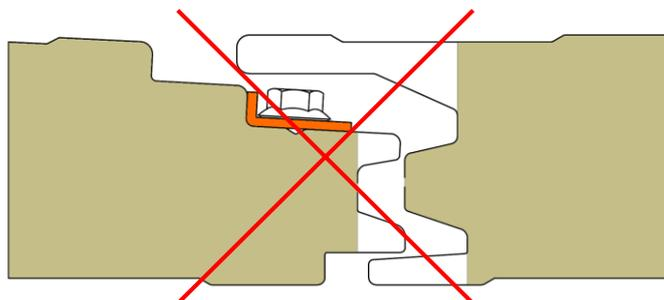
Si ricorda di prestare molta attenzione al corretto serraggio delle viti, poiché in caso per esempio di serraggio eccessivo si corre il rischio di deformare il giunto e causare imperfezioni.
