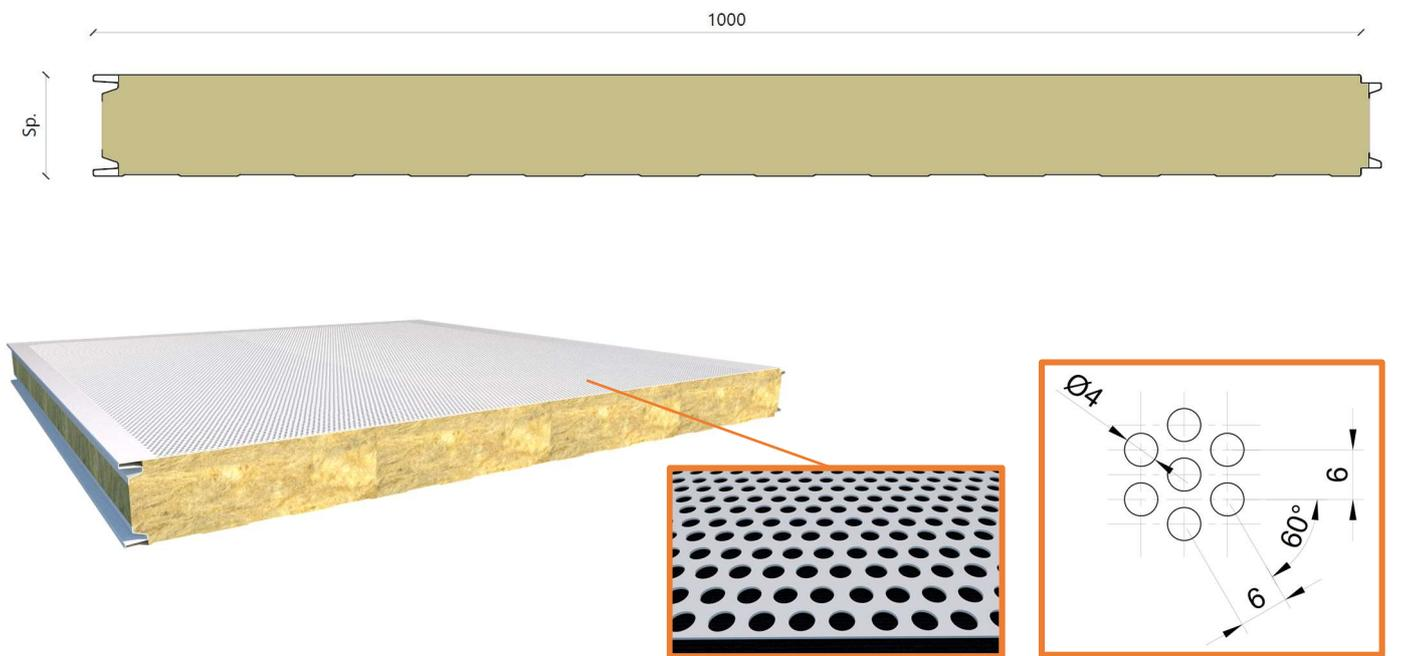
Per incrementare le proprietà acustiche, il supporto metallico sul lato interno dei pannelli è forato con fori da 4mm di diametro (R4T6), disposti a triangolo con mutuo interasse di 6 mm, per generare una disposizione periodica.
