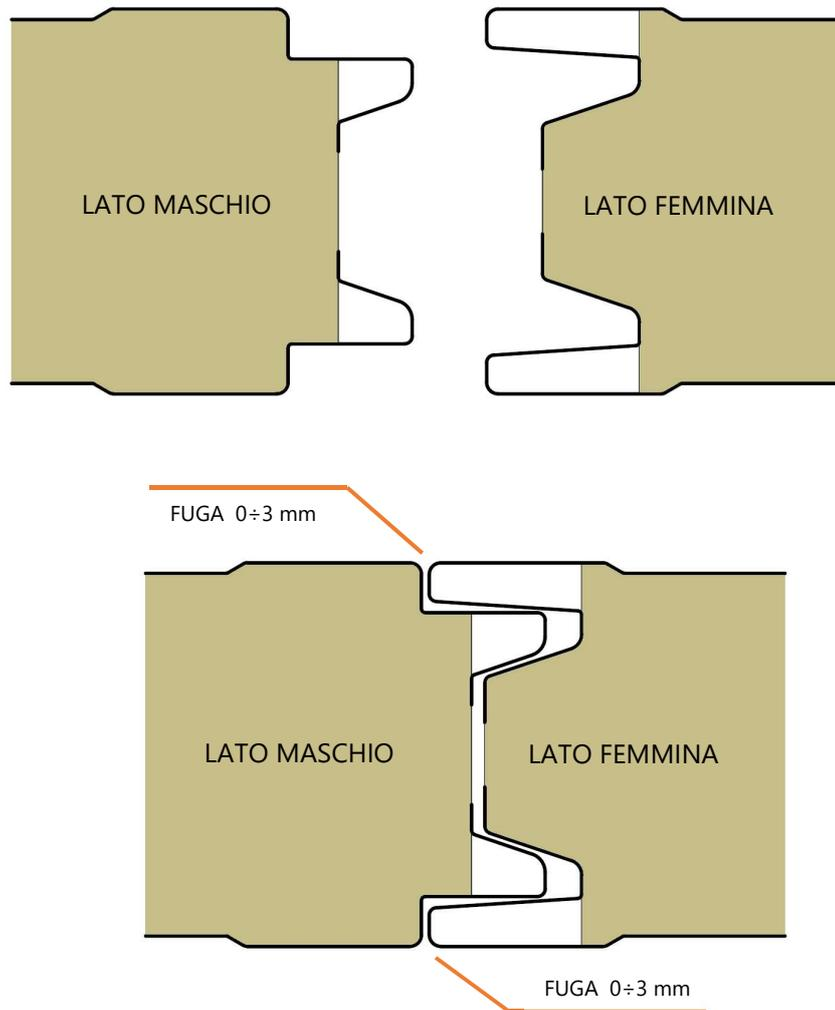
Il giunto maschio - femmina a vista ideato da Marcegaglia Buildtech prevede l'utilizzo di un sistema di fissaggio alla struttura metallica (definita in fase di progettazione) con viti selezionate in modo corretto.
