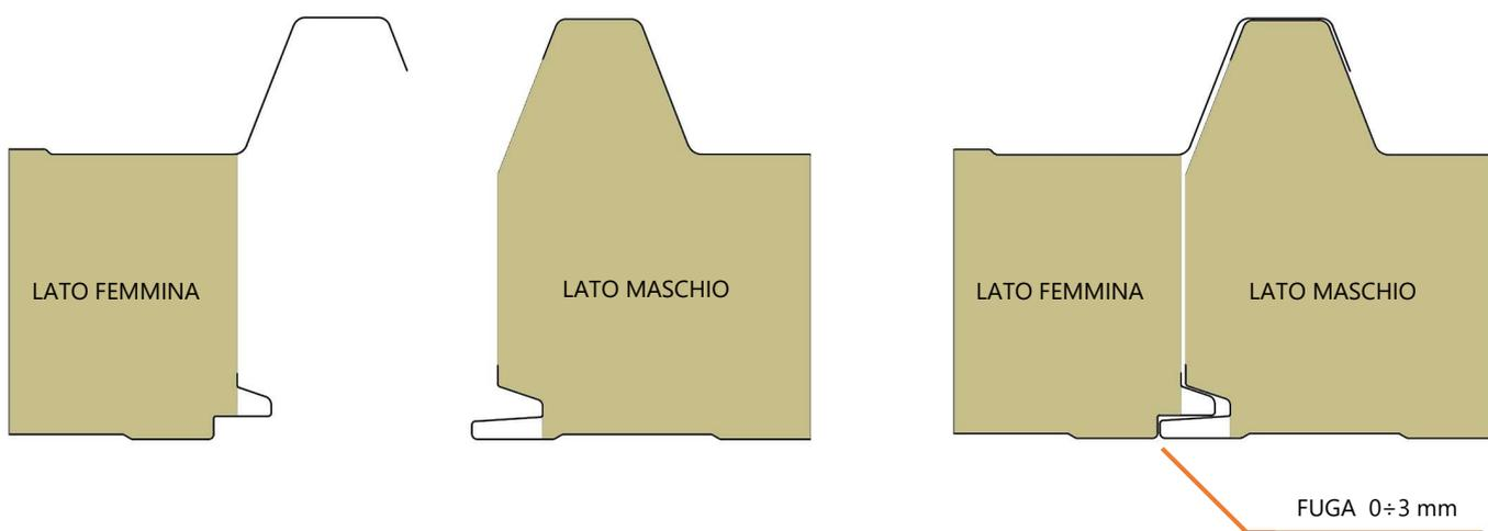
Il giunto maschio-femmina ideato da Marcegaglia Buildtech prevede l'utilizzo di un sistema di fissaggio alla struttura metallica (definita in fase di progettazione) con viti passanti in corrispondenza della greca selezionate in modo corretto.
