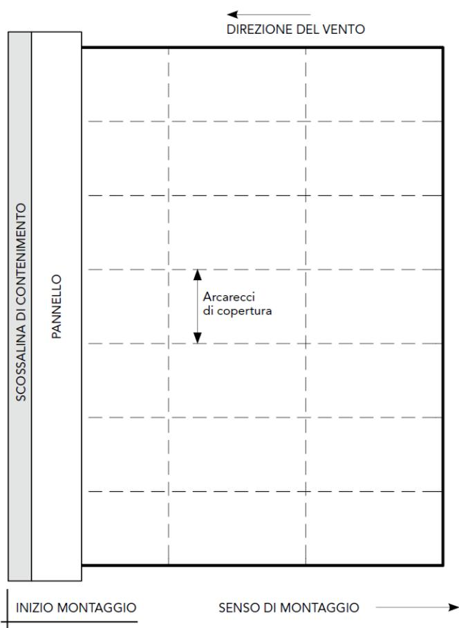
Fissato con cura il punto di partenza e verificati gli allineamenti rispetto alle carpenterie, è possibile iniziare la posa del primo pannello di copertura, **seguendo il senso di montaggio** previsto.
