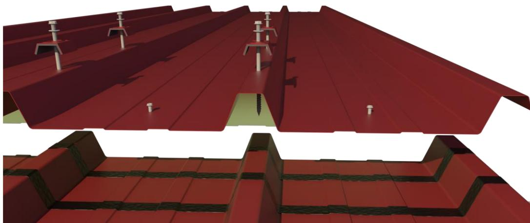
Vista frontale di un sormonto realizzato utilizzando due strisce di sigillante intumescente posizionate sul supporto grecato del pannello sottostante, due viti con cappellotto per greca e viti di cucitura sulla parte piana.
