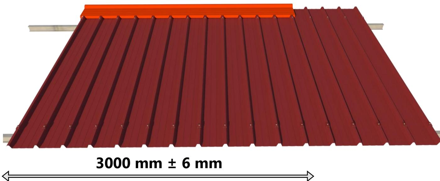
È molto importante prestare attenzione al corretto accostamento dei pannelli in fase di montaggio (3 pannelli = 3000 mm ± 6 mm) così da evitare problemi nella successiva fase di montaggio del colmo.
