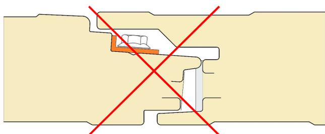
Si ricorda di prestare molta attenzione al corretto serraggio delle viti, poiché in caso per esempio di serraggio eccessivo si corre il rischio di deformare il giunto e causare imperfezioni.
