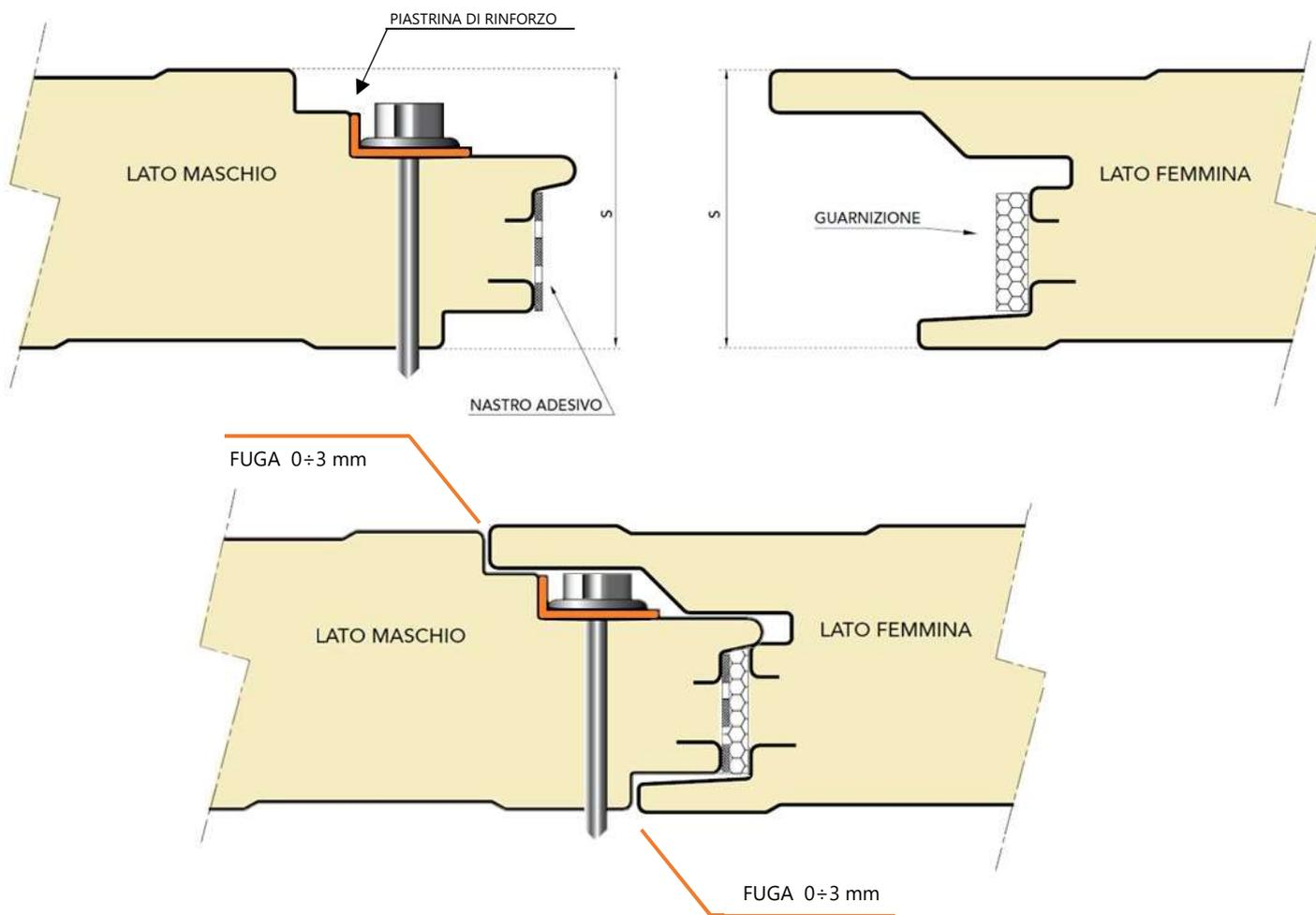
Il giunto a fissaggio nascosto ideato da Marcegaglia Buildtech, grazie alla propria sagomatura, permette la realizzazione di pareti che ammettono sistemi di fissaggio a scomparsa garantendo comunque la funzionalità del prodotto.
