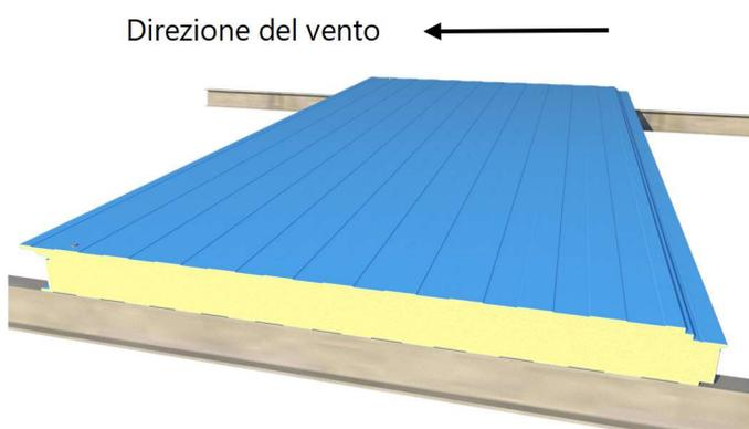
Fissare la parte femmina del primo pannello alla carpenteria retrostante e successivamente la parte maschio mediante le viti di fissaggio interponendo tra le viti e il pannello una piastrina di rinforzo in acciaio.
