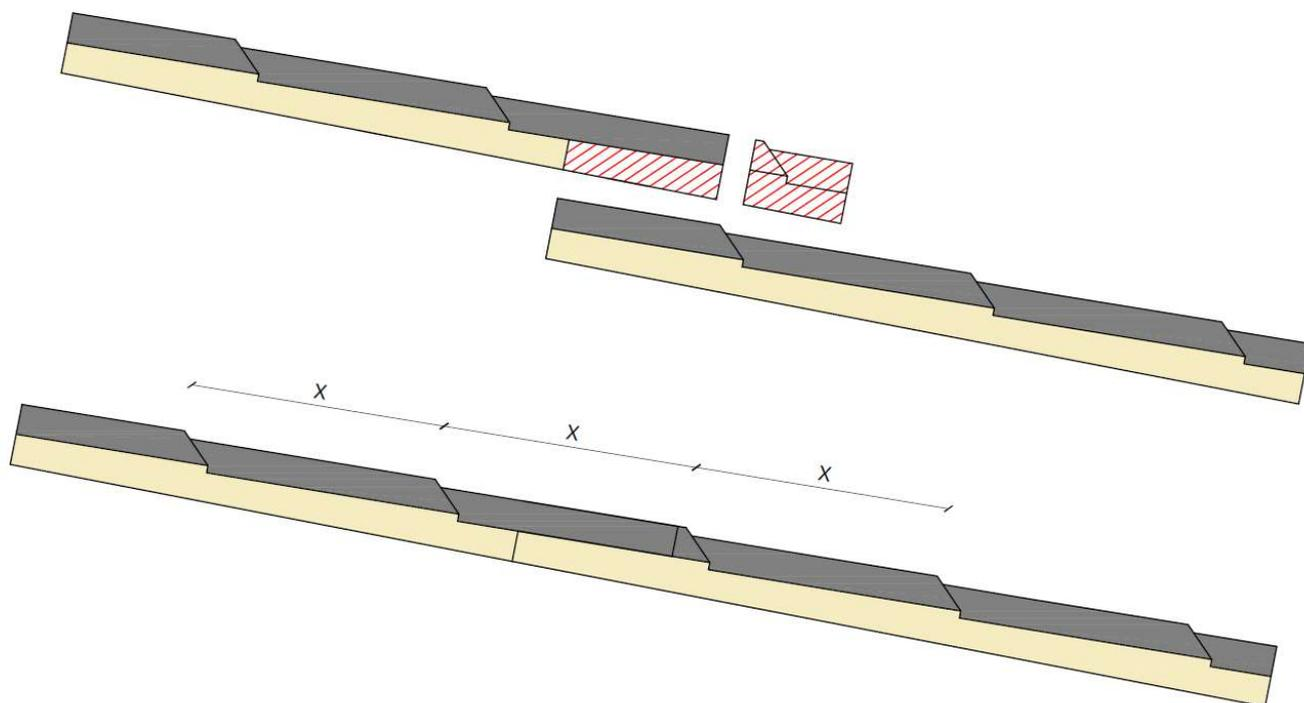
Metodo di sormonto che prevede il taglio di una porzione di pannello e la successiva asportazione della schiuma poliuretanic in prossimità della testa del pannello a monte che viene sovrapposto a quello a valle.
