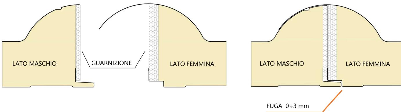
Il giunto maschio - femmina del pannello MB COPPO ideato da Marcegaglia Buildtech prevede l'utilizzo di un sistema di fissaggio alla struttura metallica (definita in fase di progettazione) con viti selezionate in modo corretto e apposita rondella batz. Le guarnizioni inserite in fase di produzione aiutano a migliorare le prestazioni di ermeticità del giunto.
