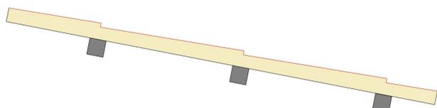
Sezione trasversale di un pannello MB COPPO in cui è possibile notare il passo dei coppi a 350 mm.
