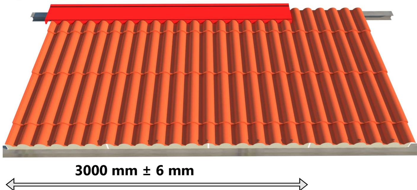
È molto importante prestare attenzione al corretto accostamento dei pannelli in fase di montaggio (3 pannelli = 3000 mm ± 6 mm) così da evitare problemi nella successiva fase di montaggio del colmo.
