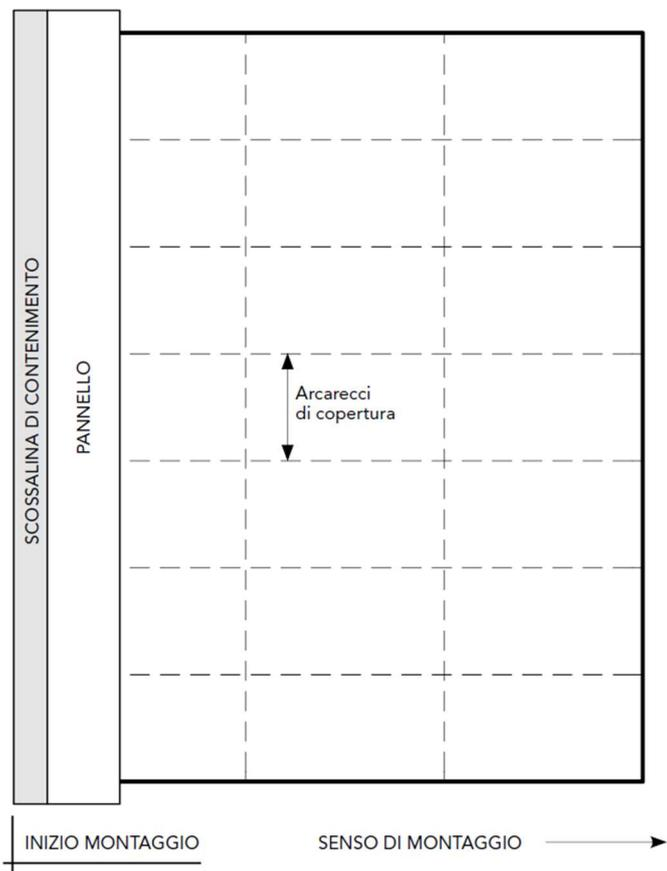
Fissato con cura il punto di partenza e verificati gli allineamenti rispetto alle carpenterie, è possibile iniziare la posa del primo pannello di copertura, **segundo il senso di montaggio** previsto.
