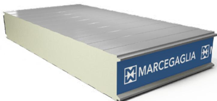
I pannelli si differenziano per un elevato grado di isolamento raggiunto grazie agli spessori dell'anima poliuretanic (150-200 mm) e alla particolare tecnologia del giunto. La conformazione del giunto risulta particolarmente adatta alla tenuta meccanica e termica e permette, inoltre, l'alloggiamento di sigillante per migliorare la tenuta dell'aria.
