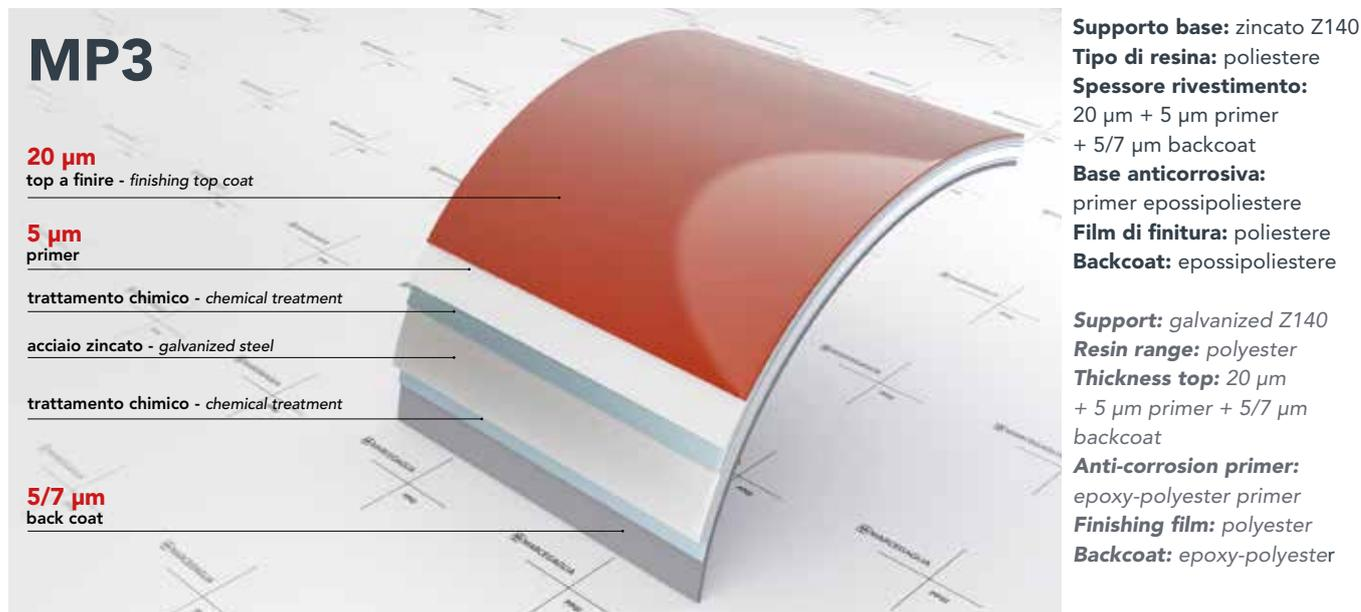
La flessibilità del processo coil coating Marcegaglia rende possibile l'offerta di un'ampia gamma di finiture superficiali e di diversi colori: il laboratorio di ricerca e sviluppo Marcegaglia ha codificato oltre 140 cicli standard di verniciatura e finitura su entrambe le facce del materiale.
